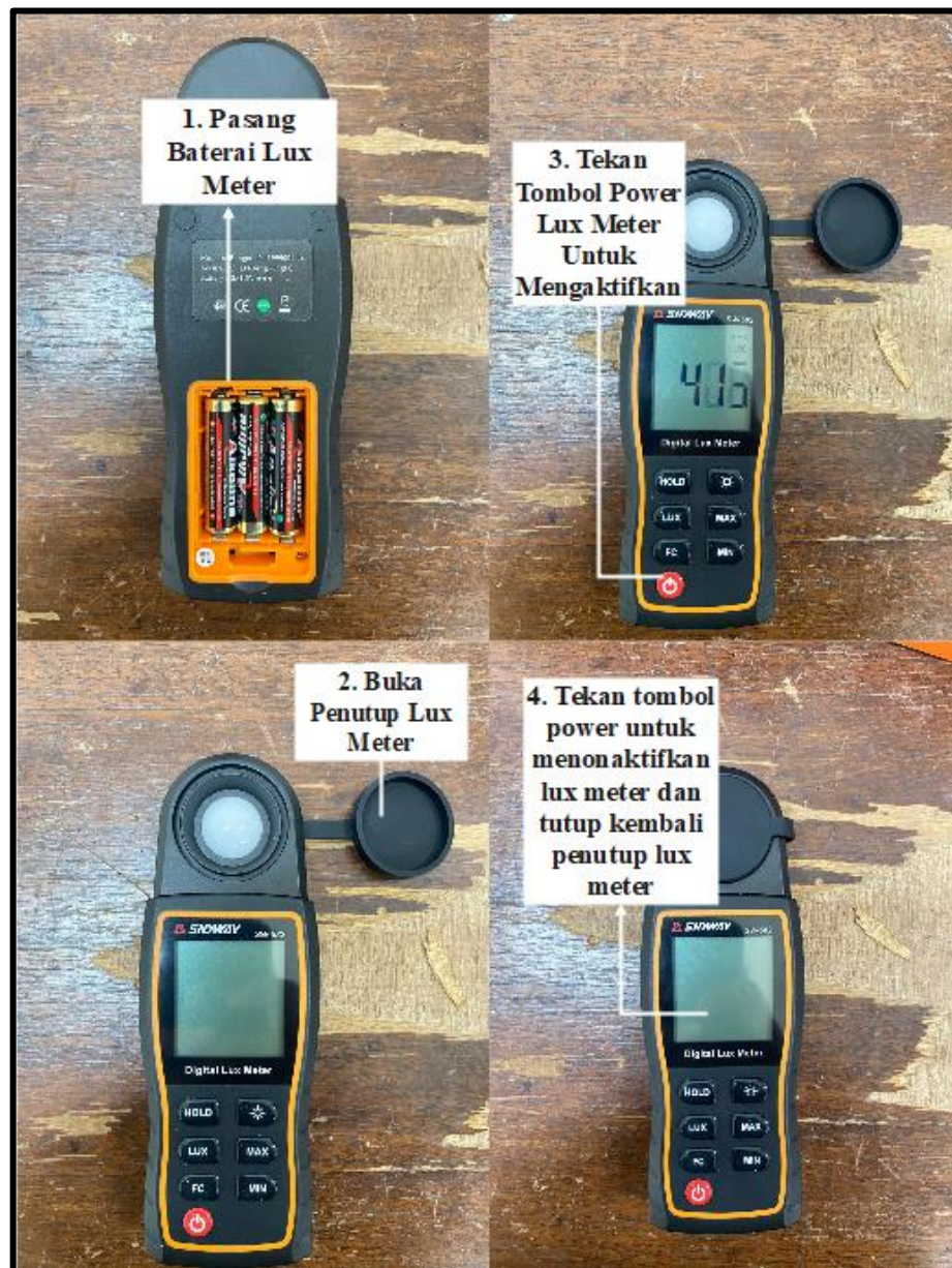
Gambar 4. 27 Langkah-Langkah Menggunakan Lux Meter
