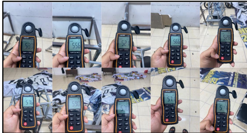
Gambar 4. 33 Bukti Pengukuran Lux Ruang Alat GE 309
