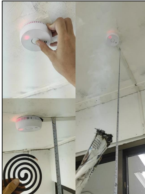
Gambar 4. 23 Pengujian Sensor Asap
