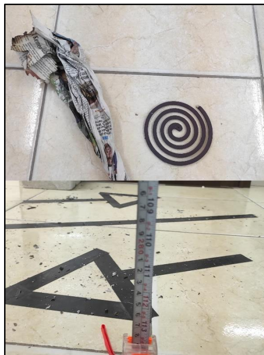
Gambar 4. 37 Pengukuran Ketinggian Dan Media Pembakaran Untuk Sensor Asap
