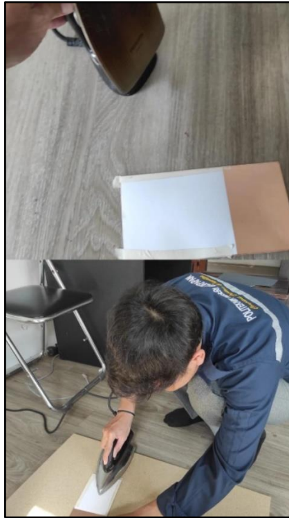
Gambar 4. 6 Proses Pencetakan Dengan Setrika
