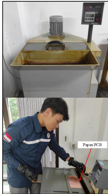
Gambar 4. 8 Proses Pelarutan Jalur Dengan Metode Single Layer
