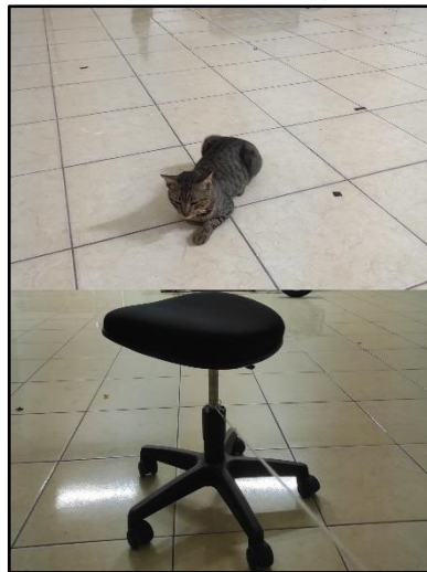
Gambar 4. 39 Pengujian Sensor PIR Terhadap Kucing Dan Kursi Beroda
