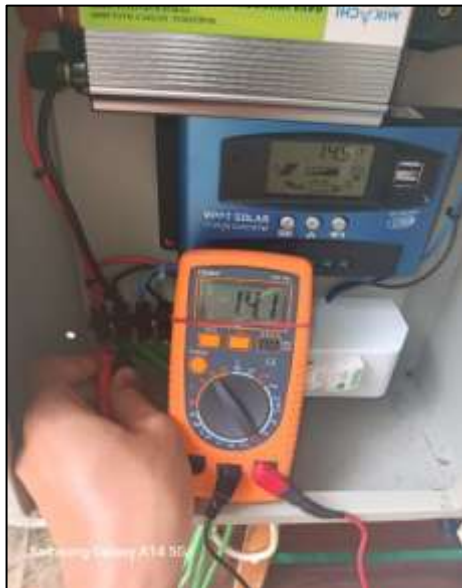
Gambar 4 5 Pengujian Mppt Ke baterai/Aki
