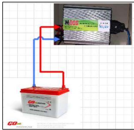
Gambar 4 7 Perancangan Wiring Baterai/Aki Ke Inverter
