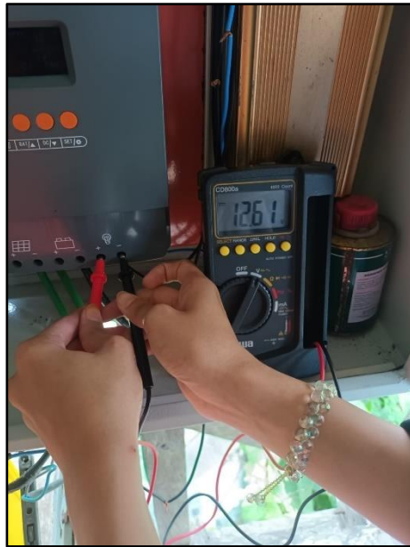
Gambar 4.15 Pengukuran Tegangan Beban Tanpa Kincir Angin
