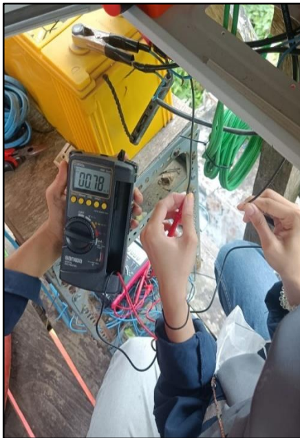
Gambar 4.10 Pengukuran Arus Output Generator DC
