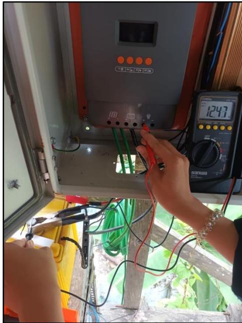
Gambar 4.19 Pengukuran Tegangan Dari Aki Ke Lampu
