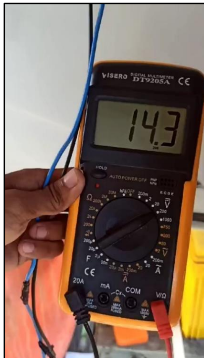
Gambar 4.9 Pengukuran output pada kincir angin pada saat berputar
