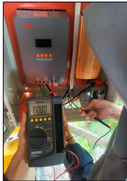
Gambar 4.14 Pengukuran Arus Beban saat kincir angin berputar
