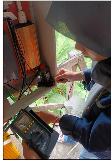
Gambar 4.16 Pengukuran Arus Beban Tanpa Kincir Angin
