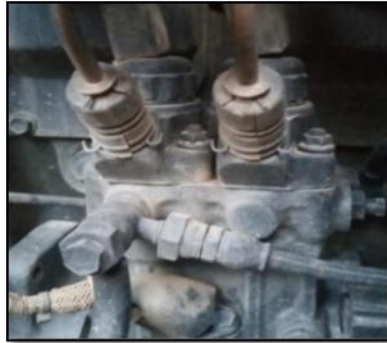
Gambar 2. 7 Supply Pump (Sumber : Dokumentasi pribadi)
