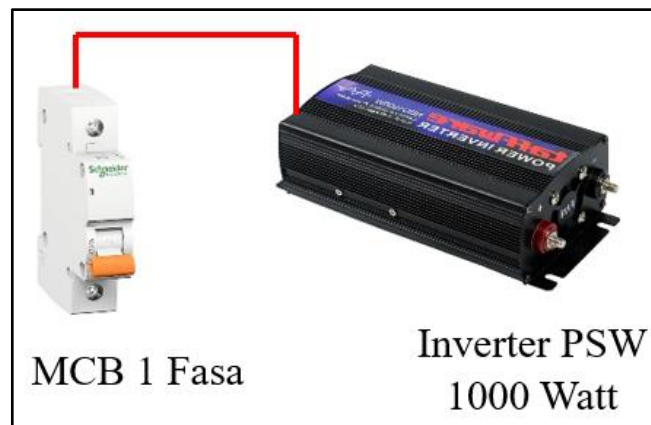
Gambar 4.5 Wiring dari Inverter Pure Sine Wave 1000 Watt ke MCB 1 Fasa
