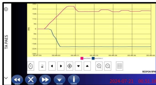
Gambar 4. 31 Hasil Pengujian Dengan K_i = 29 K_p = 15 K_d = 0
