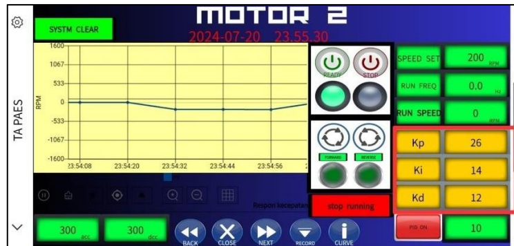
Gambar 4. 27 Setting Parameter PID Pada SCADA
