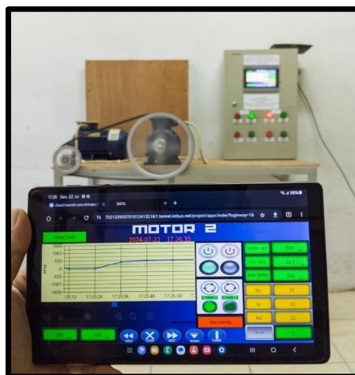
Gambar 4. 20 Tampilan Sistem SCADA Melalui Smartphone dan Laptop
