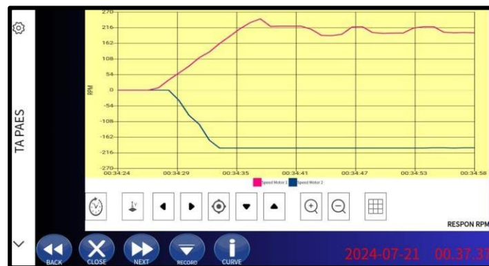
Gambar 4. 30 Hasil Pengujian Dengan K_p = 29 K_i = 1 K_d = 0
