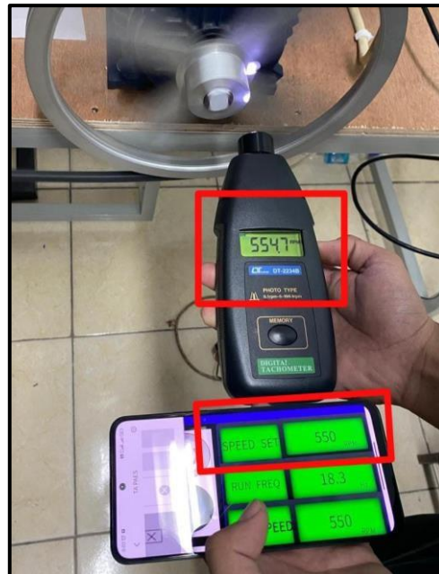
Gambar 4. 22 Pengukuran Kecepatan Dengan Taco Meter
