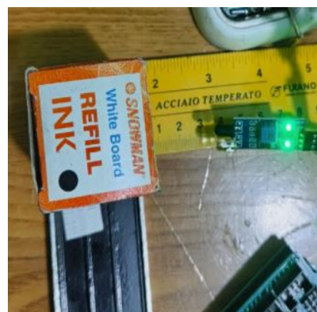
Gambar 4. 12 Pengujian Sensor infrared (jarak 4 cm)
