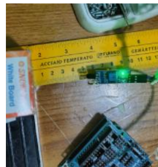
Gambar 4.14 Pengujian Sensor infrared (jarak 6 cm)
