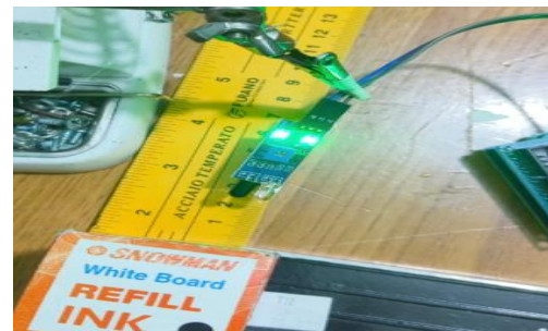
Gambar 4.10 Pengujian Sensor infrared (jarak 2 cm)
