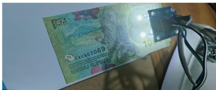
Gambar 4.2 Pengujian Sensor warna Tcs 3200
