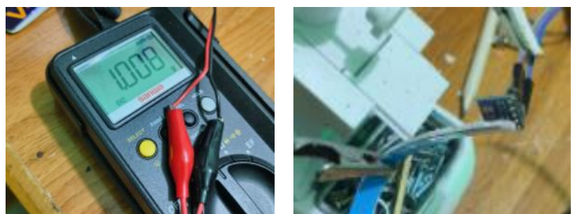
Gambar 4.5 Pengujian Sensor Ultra Violet (kondisi gelap)
