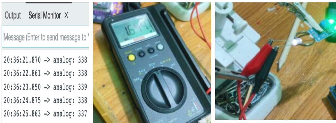
Gambar 4.7 Pengujian Sensor LDR (Kondisi Redup)
