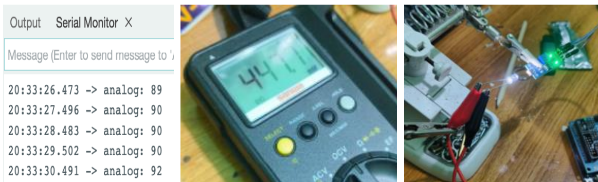
Gambar 4.6 Pengujian Sensor LDR (Ada cahaya)
