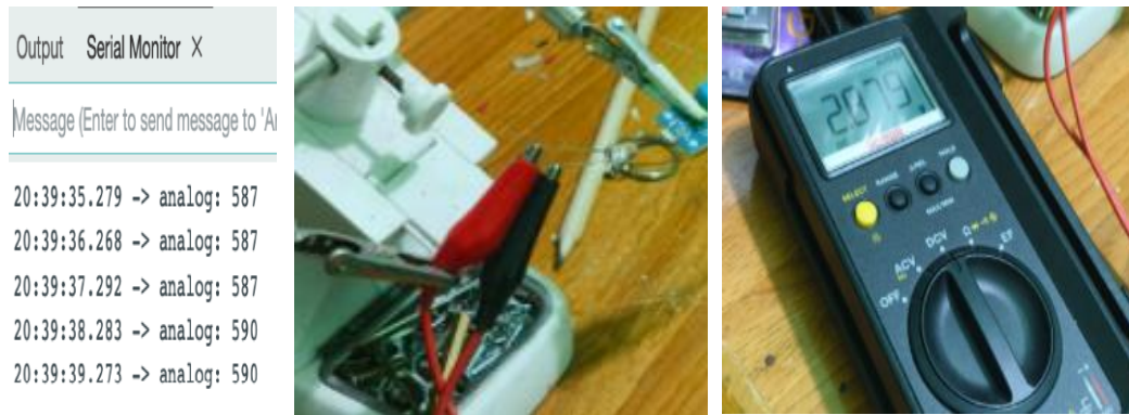
Gambar 4.8 Pengujian Sensor LDR (Kondisi gelap)
