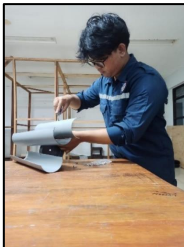
Gambar 4. 4 Pemasangan Baling Baling Kincir angin
