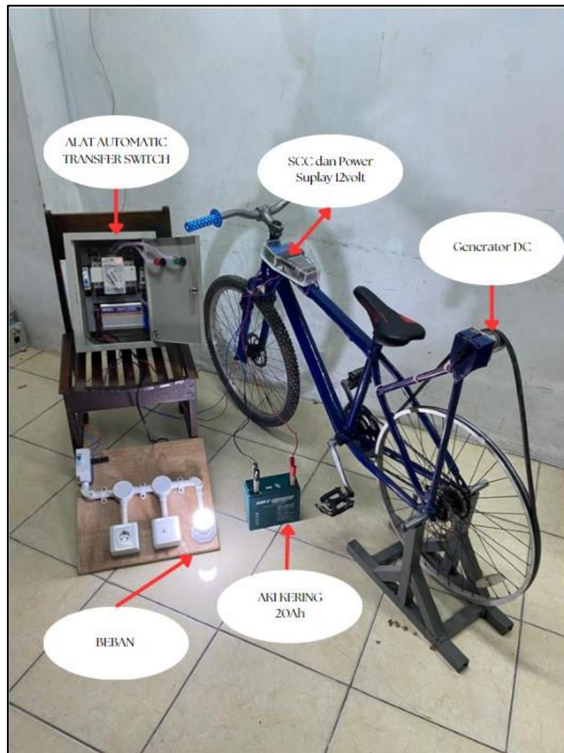
Gambar 4. 8 Sepeda Statis Pembangkit Listrik
