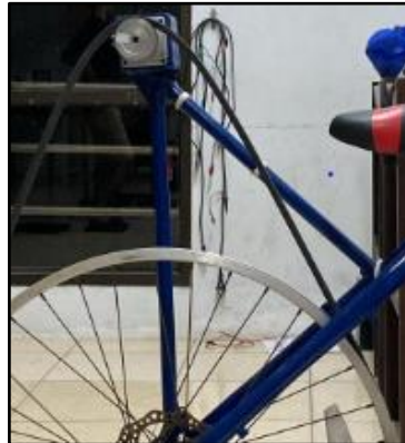
Gambar 4. 2 Rangka Dudukan Generator
